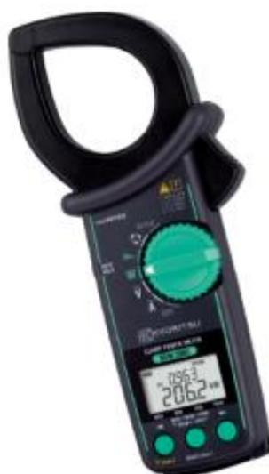
**Клещи в форме капли с диаметром проводника 55 мм: удобно использовать в небольшом офисе или на заводе.**
