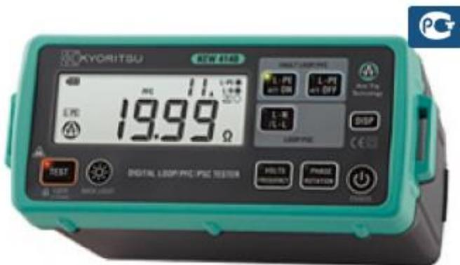
В модели KEW 4140 используется технология Anti-Trip (ATT), которая электрически отключает УЗО при проведении измерения сопротивления петли фаза-ноль. Отсутствие необходимости отсоединять УЗО во время проведения измерений позволяет сэкономить время и деньги, и делает процесс измерения безопаснее.
